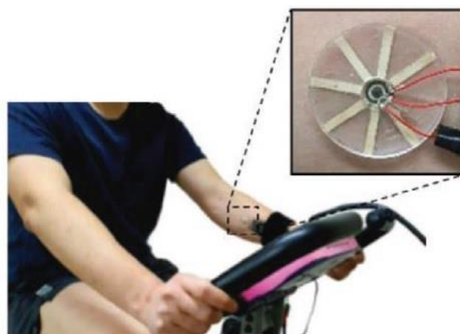
Рис. 3. Испытания “на теле”. Фотография прикрепленной к руке системы, объединяющей разработанный сборник пота (“пластырь”) и сенсор пота.
