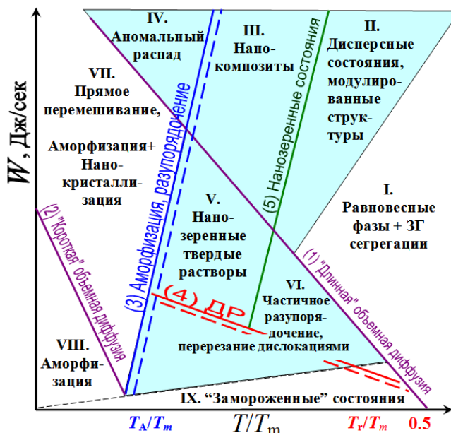
Рис.33. Диаграмма неравновесных стационарных состояний сплава в условиях интенсивной пластической деформации [A22]. Область неравновесных диффузионных фазовых превращений закрашена.
