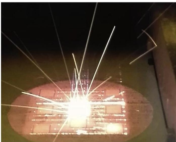
Рисунок иллюстрирует синтез образцов методом электронно-лучевой печати.
