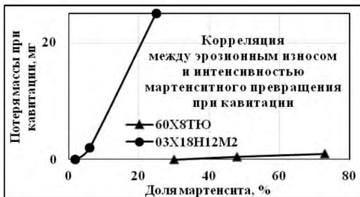
Рисунок - 2 Корреляция между эрозионным износом и интенсивностью мартенситного превращения при кавитации
