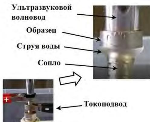
Рисунок - 1 Оригинальная схема испытаний
