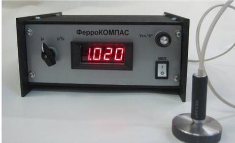
Рис. 2. Универсальный прибор ФерроКОМПАС для локального измерения магнитной проницаемости и процентного содержания ферромагнитных фаз в аустенитных сталях и сплавах.
