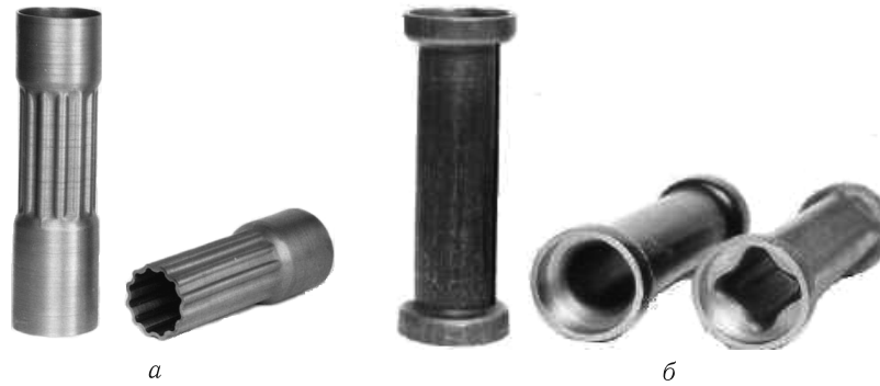
Рис. 4.5. Заготовки коленвала (а) и рулевой колонки (б)
