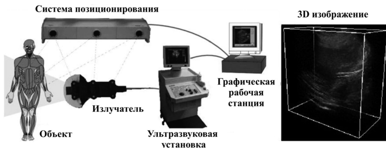
Рис. 3.5. Схема комплекса современной аппаратуры, необходимой для получения 3D изображений органов человека.
