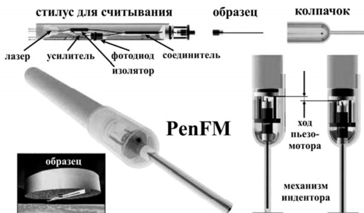
Рис. 3.6. Механический метод измерения упругих свойств поверхности биологических тканей портативным устройством. Новый инструмент (PenFM) для измерения жёсткости поверхности ткани с минимальными хирургическими манипуляциями.
