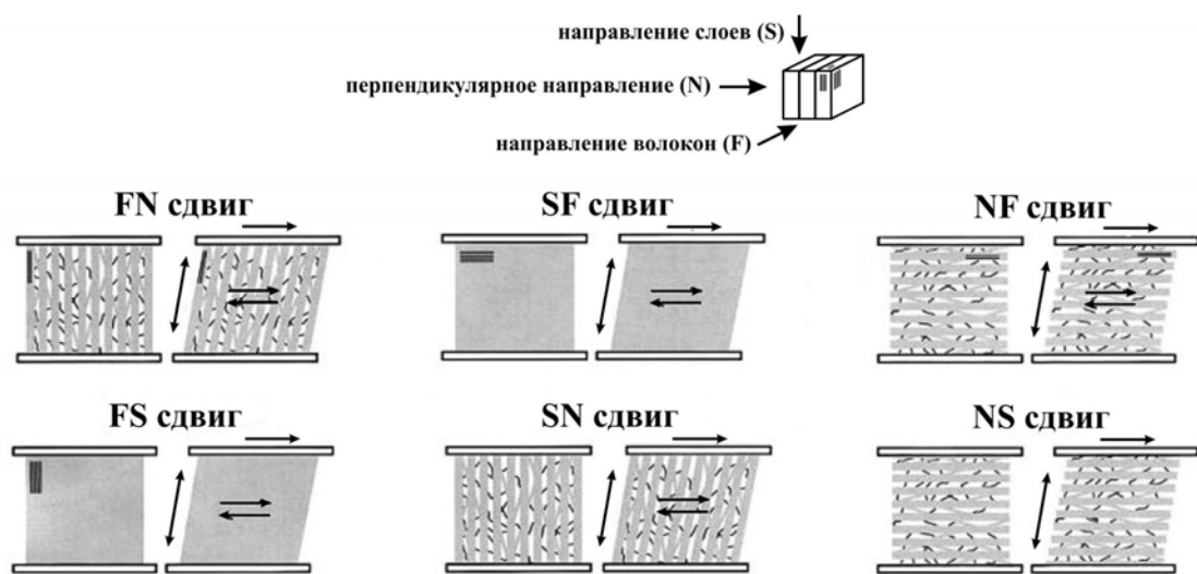
Рис. 3.12. Возможные варианты сдвиговых деформаций.
