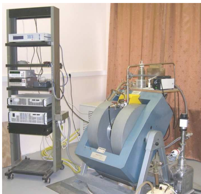
Рисунок 3.9. Установка RTF-1, используемая для исследования магнитосопротивления образцов спиновых клапанов при различных температурах.
