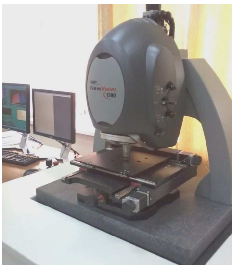
Рисунок 3.6. Вид оптического профилометра-интерферометра белого света Zygo NewView 7300 – (а), результаты измерения высоты ступеньки для материала \text{Co}_{90}\text{Fe}_{10} – (б).
