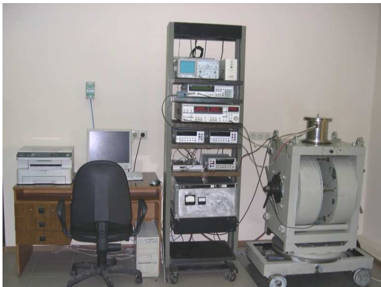
Рисунок 2.9. Автоматизированный вибрационный магнитометр АВМ-1.
