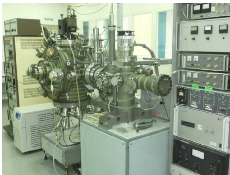
Рисунок. 2.1. Модернизированная установка молекулярно-лучевой эпитаксии «Катунь-С» (ИФМ УрО РАН).
