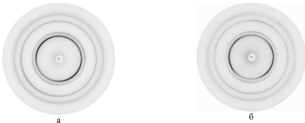
Рисунок 75. Рентгеновские дифракционные картины от образцов состава Au50Co50 ат.% обработка при криогенной температуре (80 К) и давлении 8 ГПа: а) центр образца; б) периферия образца
