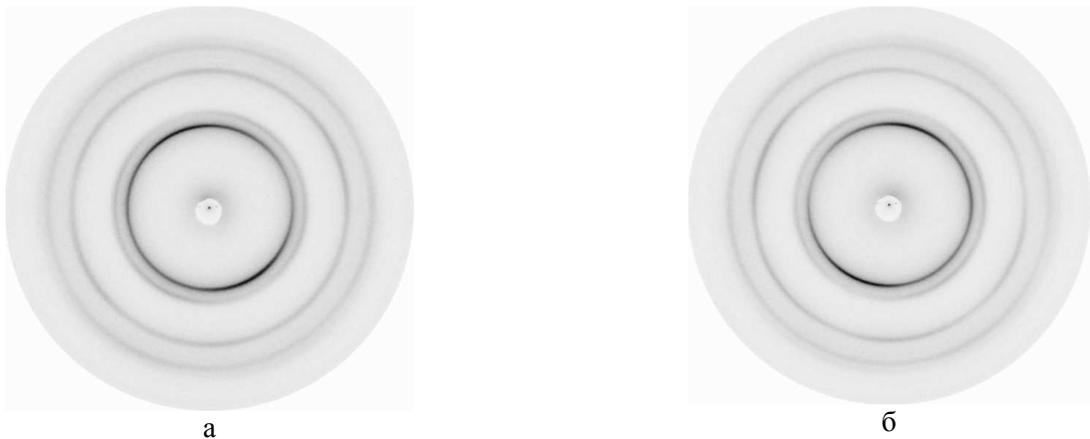
Рисунок 77. Рентгенограммы образцов системы Au50Co50 ат.%, полученные КВД-обработкой при криогенной температуре и давлении 11 ГПа: а – центр образца; б – периферия образца
