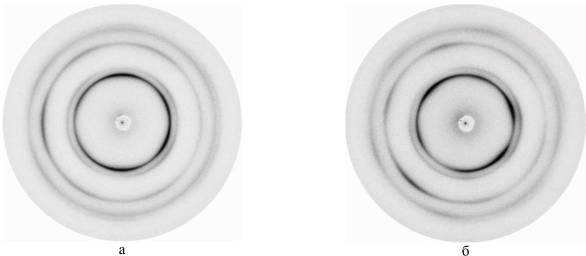
Рисунок 63. Рентгеновские дифракционные картины от образцов состава Au50Co50 ат. %, полученных при комнатной КВД-обработке (293 К): а) центр образца; б) периферия образца
