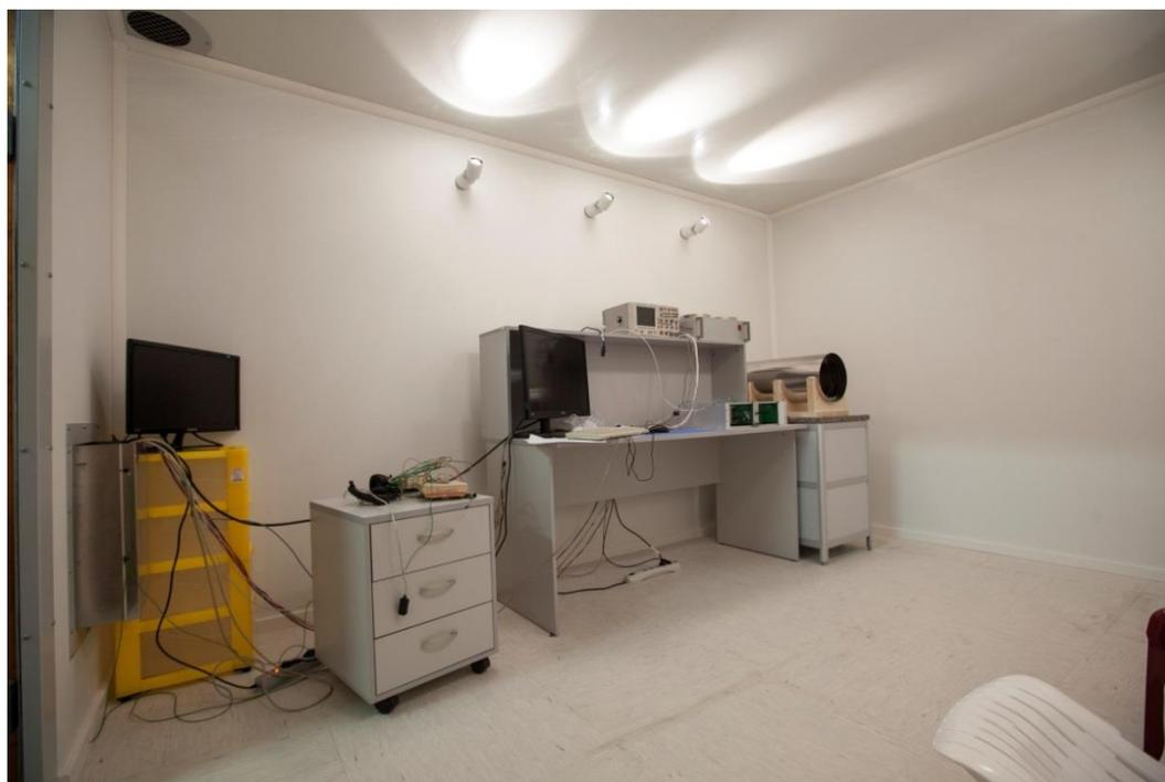
Рисунок 4.31. Магнитно экранированная комната вид внутри.
