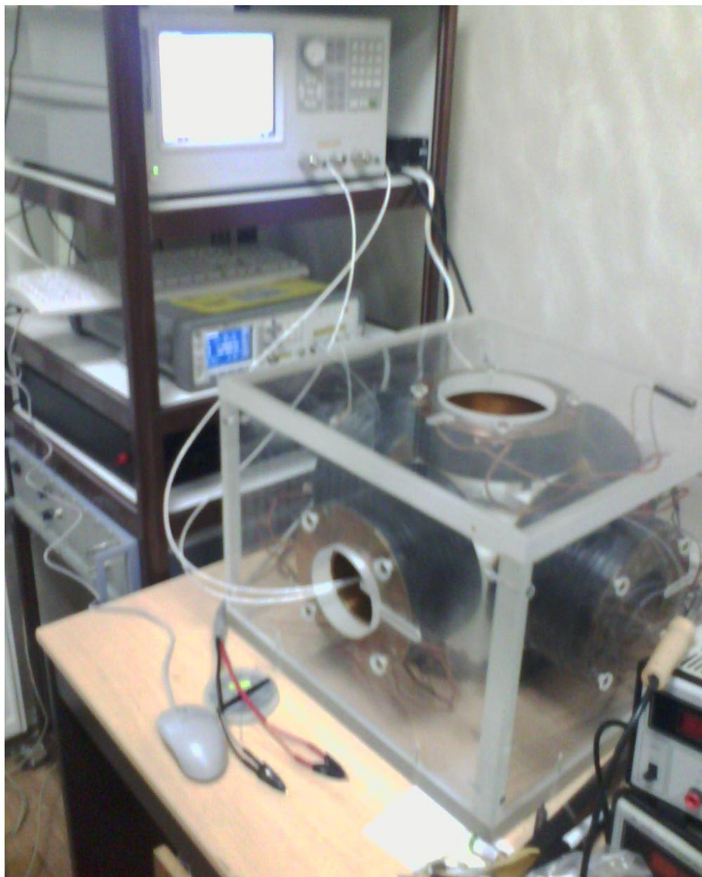
Рисунок 2.3. Общий вид установки для измерения магнитной восприимчивости феррит-гранатовых пленок радиочастотным методом.
