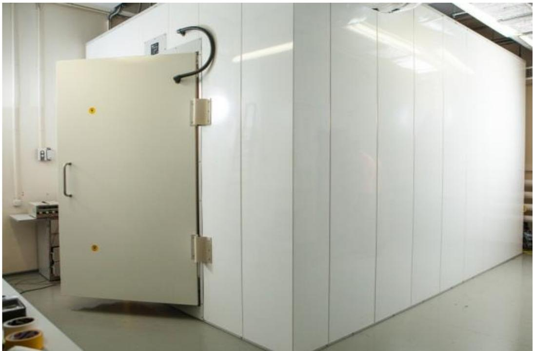
Рисунок 4.30. Магнитно экранированная комната АКЗВ (Vacuumschmelze GmbH).
