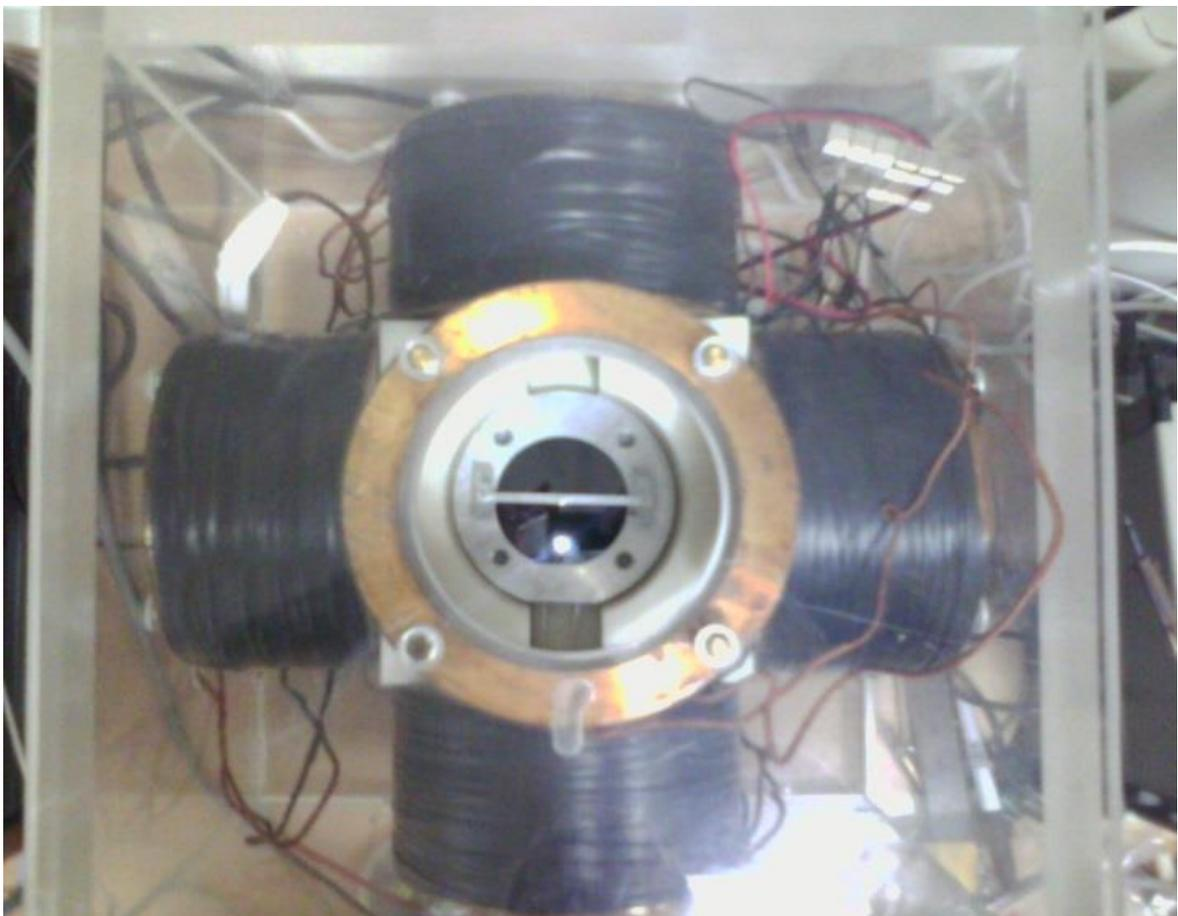
Рисунок 2.2. Система катушек Гемгольца с помещенным внутрь резонатором с феррит-гранатовой пленкой.
