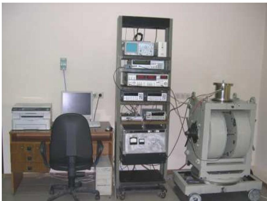
Рисунок 2.7. Внешний вид автоматизированного вибрационного магнитометра АВМ-1.
