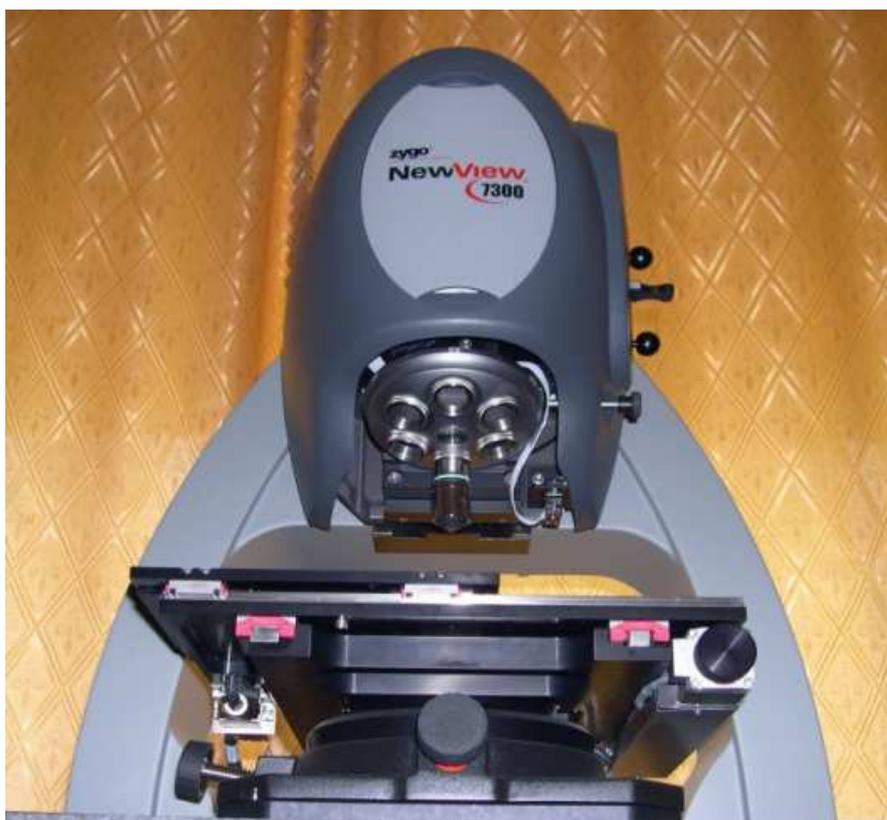
Рисунок 2.3. Внешний вид оптического профилометра-интерферометра белого света Zygo NewView 7300.
