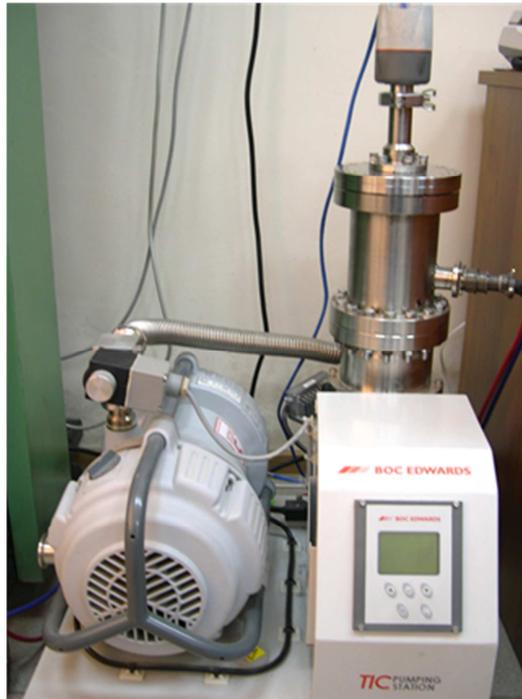
Рисунок 2.15. Внешний вид вакуумной установки для термообработки на основе откачного поста BOC EDWARDS.
