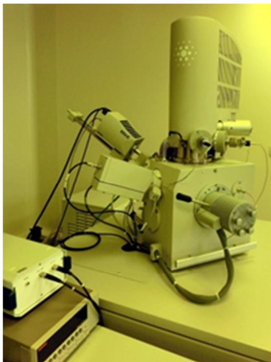
Рисунок 2.10. Общий вид колонны растрового электронного микроскопа FEI Inspect F, оснащенного энерго-дисперсионным рентгеновским спектрометром GENESIS APEX 2 EDS с системой APOLLO X SDD (ИФМ УрО РАН, центр коллективного пользования «Нанотехнологий спинтроники»).
