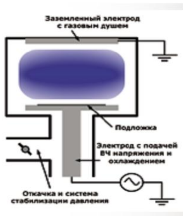
Рисунок 2.4 – Схема реактивного ионно-плазменного травления
