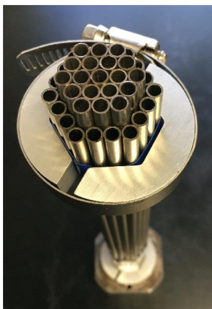
Рис. 2. Рабочее тело эластокалорического холодильника (Ichiro Takeuchi, Univ. of Maryland).
